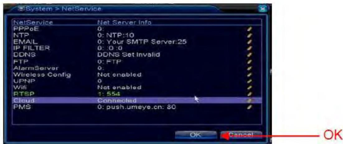
در صورتی که عباراتی مانند **not connect** (در حال اتصال) و یا **connecting** (متصل نیست) را مشاهده کردید ، یعنی که دستگاه به اینترنت متصل نشده است که احتمال زیاد در صورت اطمینان از سلامت کابل شبکه ، IP مودم با دستگاه **DVR** شما هم رنج نمی باشد . اما هم رنجی را به چه صورت انجام دهیم ؟ برای تنظیمات مودم خود باید از طریق یک سیستم کامپیوتری و یا یک لپ تاپ به مودم خود وصل شوید . بدین صورت که آدرس IP مودم خود را که اصولاً :
