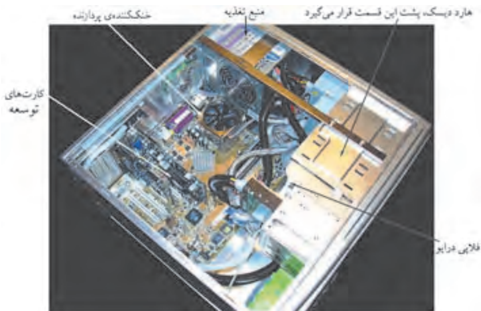
شکل ۱۸-۴ اجزای داخلی یک Case رایانه
